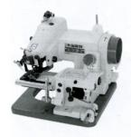
本机采用单弧针摆动刺料,摆动线钩勾线,形成103型单线链状线迹的工业缝纫机。它适用于缝制各类中等厚度织物的暗缝工序,如裤管口、袋口、上衣下摆的暗缝,袜子、手套等小口径物件的暗缝。
